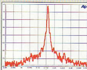
Gleichlauf-Diagramm (links): recht schmale, hohe Spitze. System (rechts): leichte Höhenanhebung, gute Kanaltrennung.
